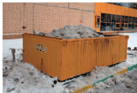
Избыточная загрузка снегоплавильной установки снегом.
